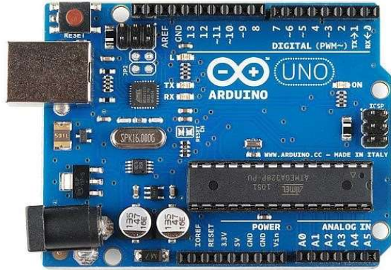
FIGURE 3: ARDUINO UNO R3
